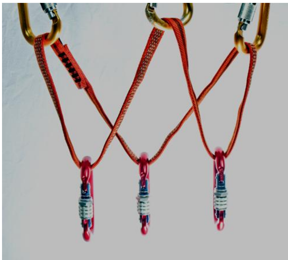
Trīspunktu trīskāršās Equalette veidošanas shēma.
